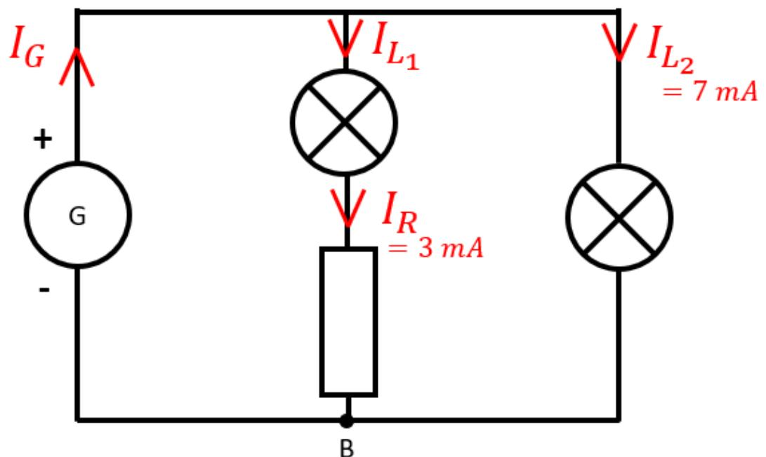
Calculer l'intensité  $I_G$  en appliquant la loi des nœuds au point B
