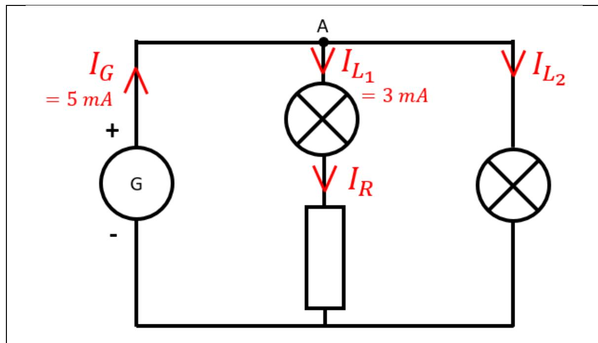
Calculer l'intensité  $I_{L_2}$  en appliquant la loi des nœud au point A :
